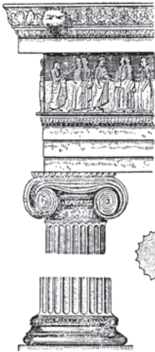
Колонна в ионическом стиле.
